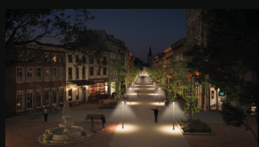
2 Am Abend schmale Lichtverteilung und reduzierte Lichtintensität.
